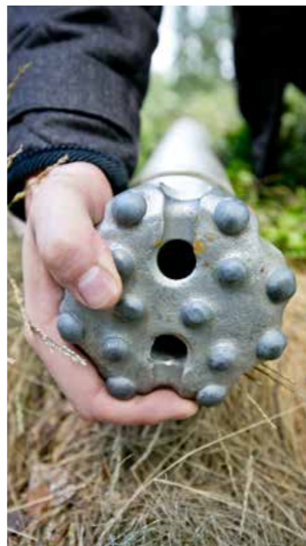
▲ HARDT: Fjellet i Holmenkollåsen er hardt, så det må et kraftig borehode til for å grave ut energibrønnene. Østre Kragstegen boligsameie har gode naturlige forutsetninger for å ta i bruk bergvarmeteknologi.
